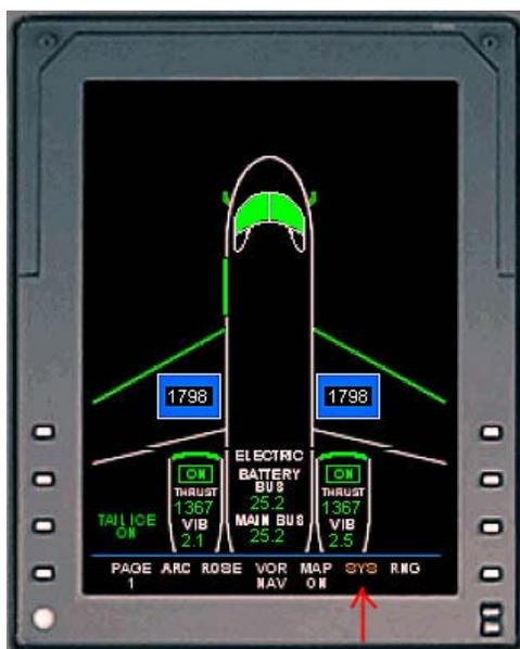
Cette page montre les systèmes de l'avion et leur état, incluant le carburant, les systèmes anti-givre, les systèmes électriques, les moteurs et les portes. ☺
